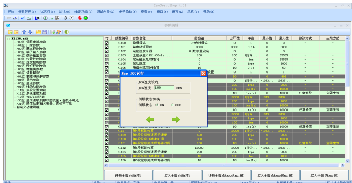
图 5-5 JOG 使用方法示意图
