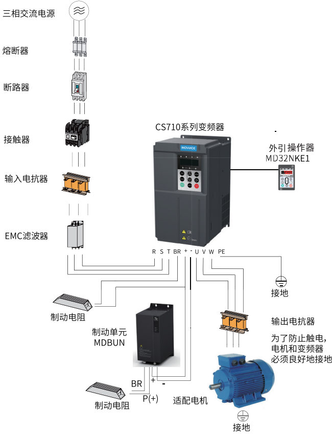
图 2-1 CS710 系列系统构成
